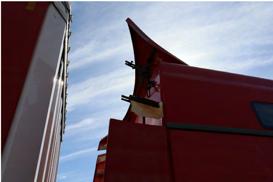
Bild 42 : Spoilerecke re.oben gebrochen/fehlt
