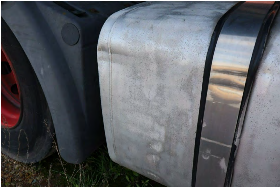
Bild 36 : Tank & Tankband re.deformiert
