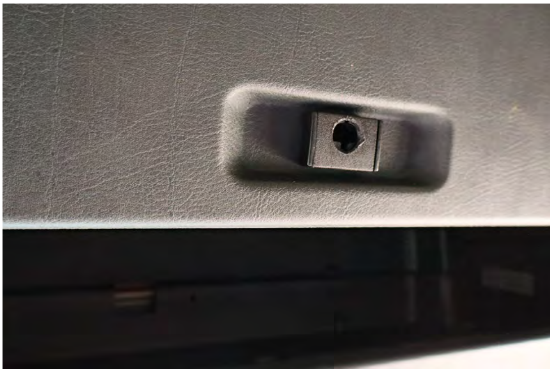
Bild 12 : div.Verkleidungen A-Tafel gebrochen/angebohrt
