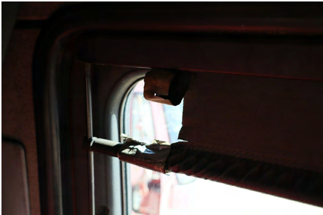
Bild 44 : Sonnenschutzrollo Tür li. gerissen
