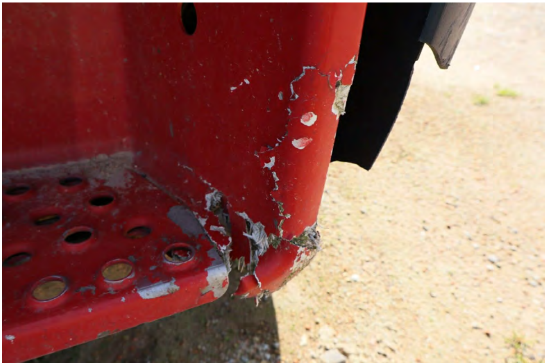
Bild 28 : Einstieg unten re.gebrochen
