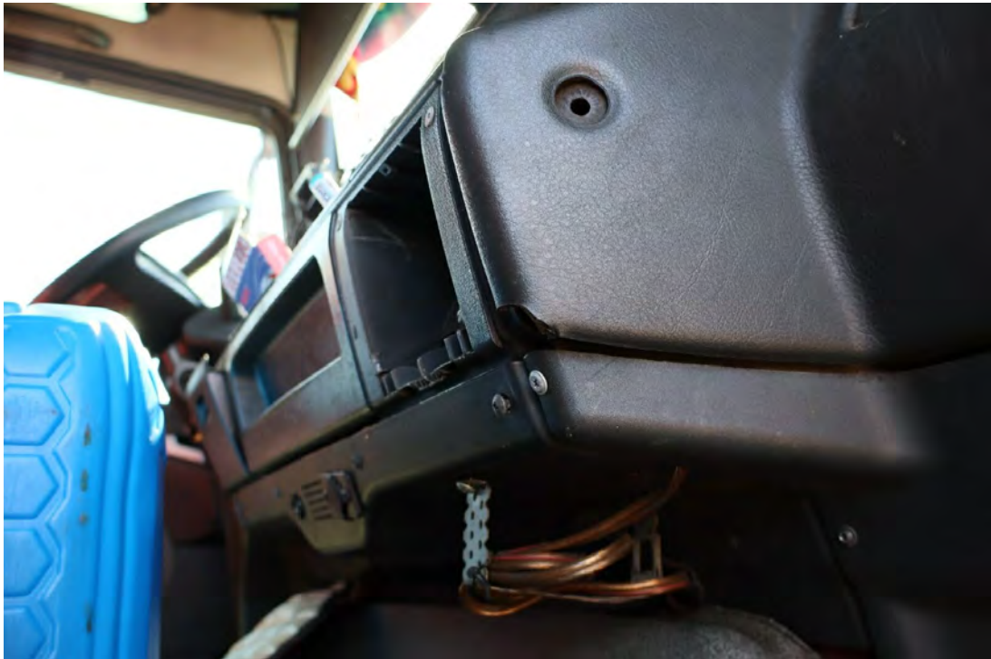
Bild 13 : div.Verkleidungen A-Tafel gebrochen/angebohrt
