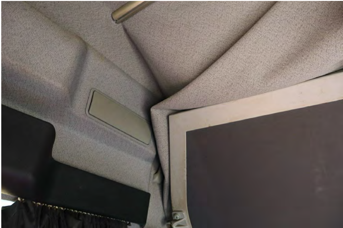
Bild 7 : Dachhimmel löst sich ab
