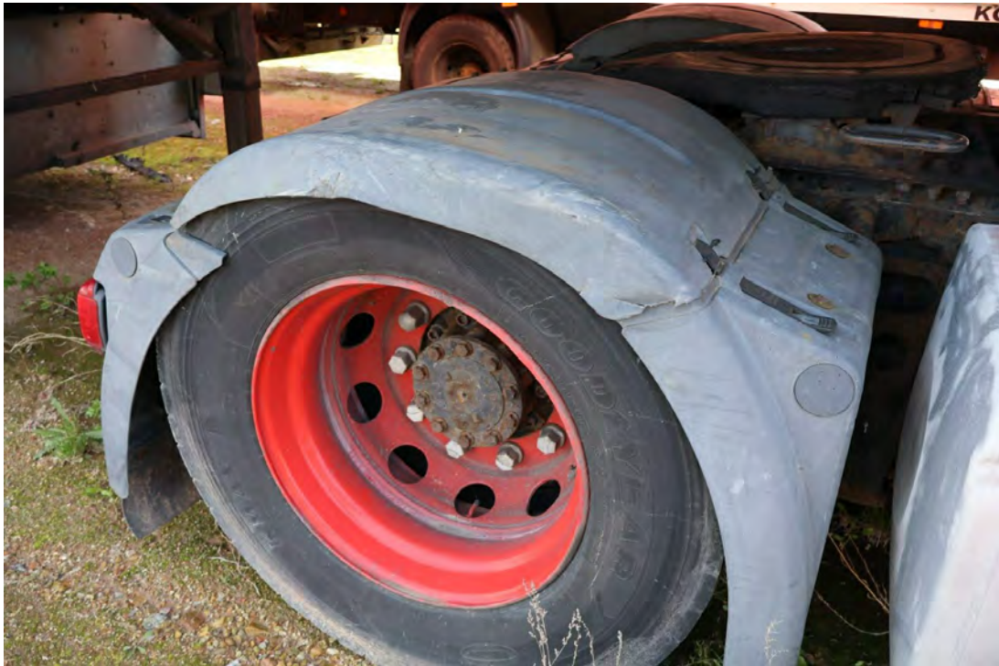
Bild 37 : Radabdeckung / Kotflügel hi.re.gebrochen
