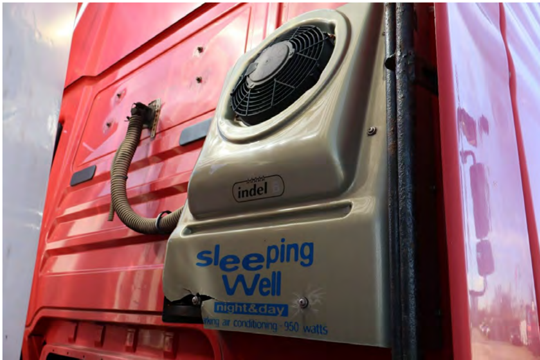
Bild 43 : Abdeckung Standklimaanlage gebrochen
