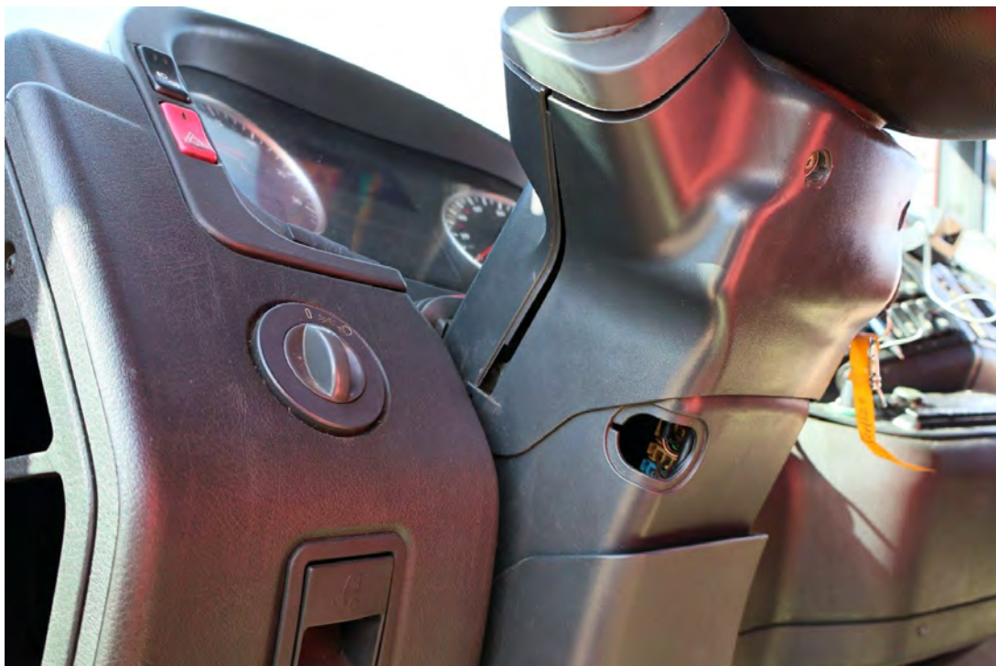
Bild 11 : div.Verkleidungen A-Tafel gebrochen/angebohrt
