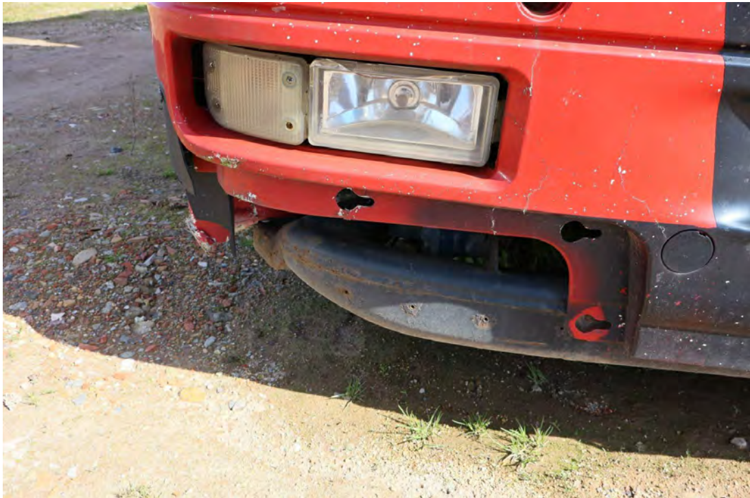
Bild 27 : Stoßfängerecke unten re.fehlt
