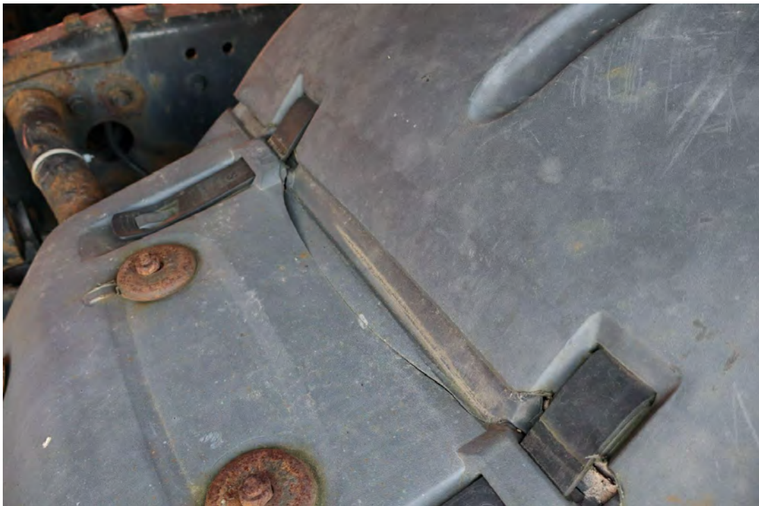
Bild 38 : Radabdeckung / Kotflügel hi.re.gebrochen
