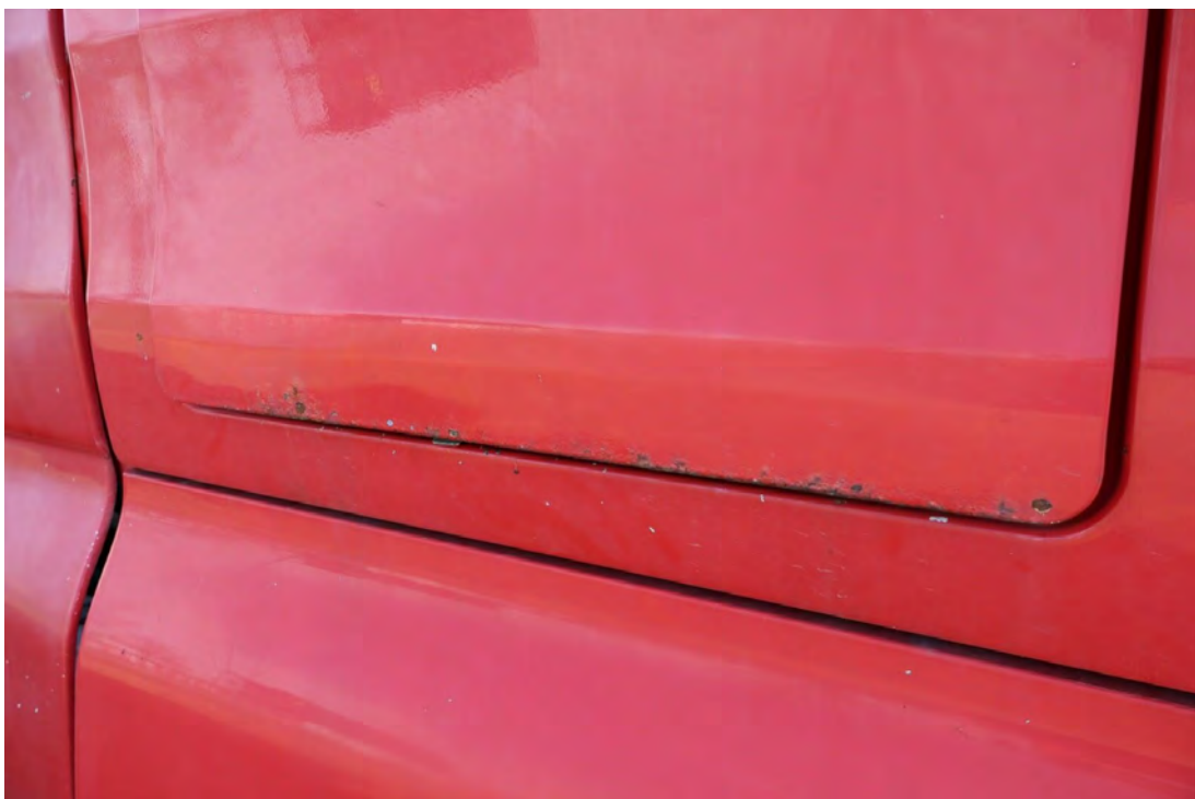
Bild 34 : Rostansatz Stauraumklappe re.
