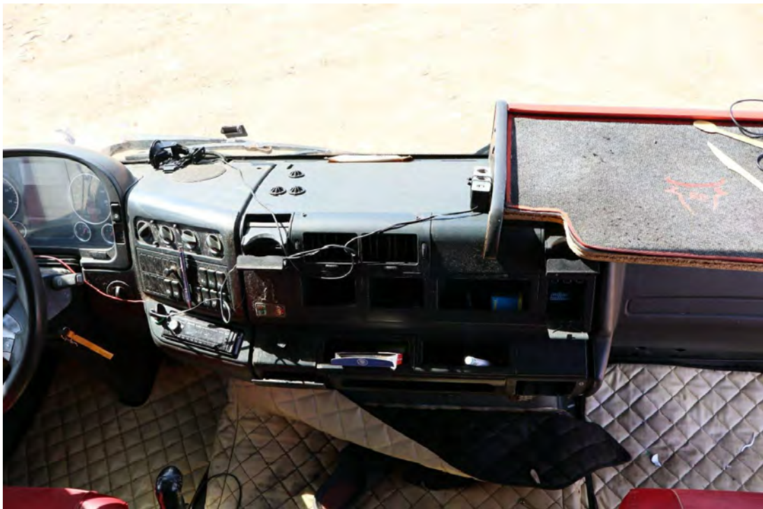
Bild 8 : div. Verkleidungen A-Tafel gebrochen/angebohrt
