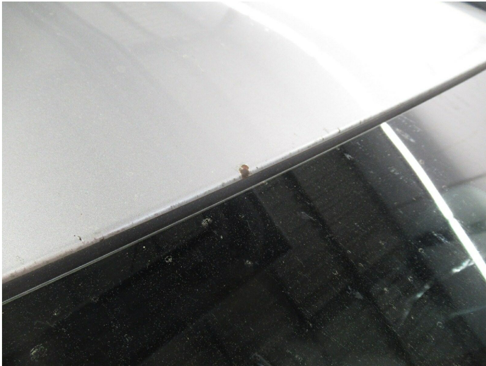
Bild 7 : Dach Lackierung, Steinschlag, Gebrauchsspur
