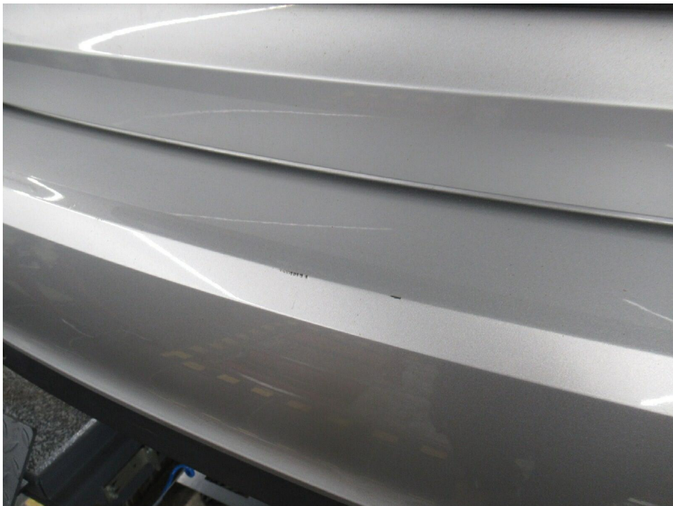
Bild 8 : Stoßfänger hinten Lackierung, verschrammt, Gebrauchsspur
