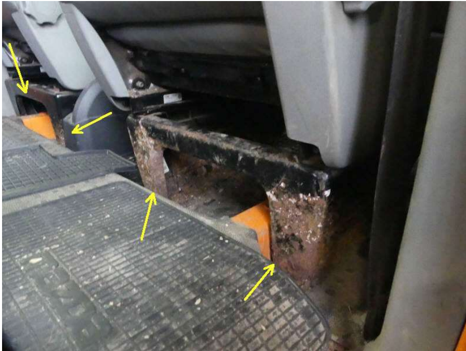
Bild 17 Sitzgestelle vorn links und rechts korrodiert
