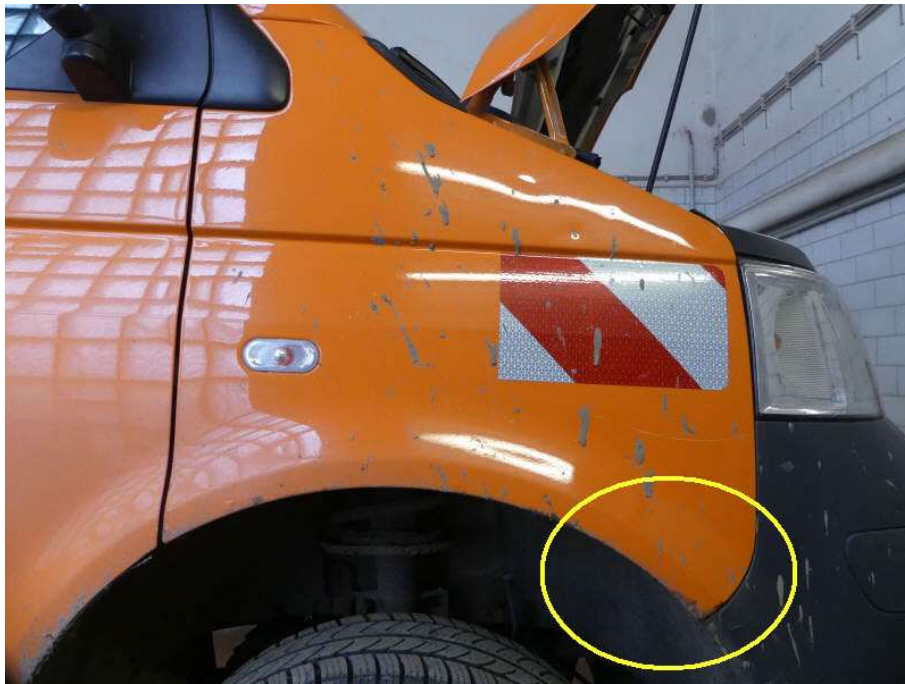
Bild 35 Kotflügel vorn rechts korrodiert
