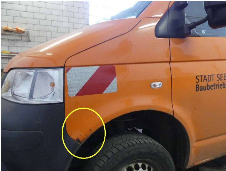
Bild 23 Kotflügel vorn links korrodiert
