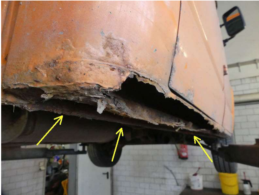
Bild 33 Unterholm rechts stark durchgerostet
