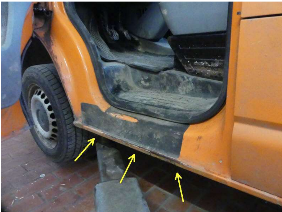
Bild 20 Einstieg vorn links korrodiert
