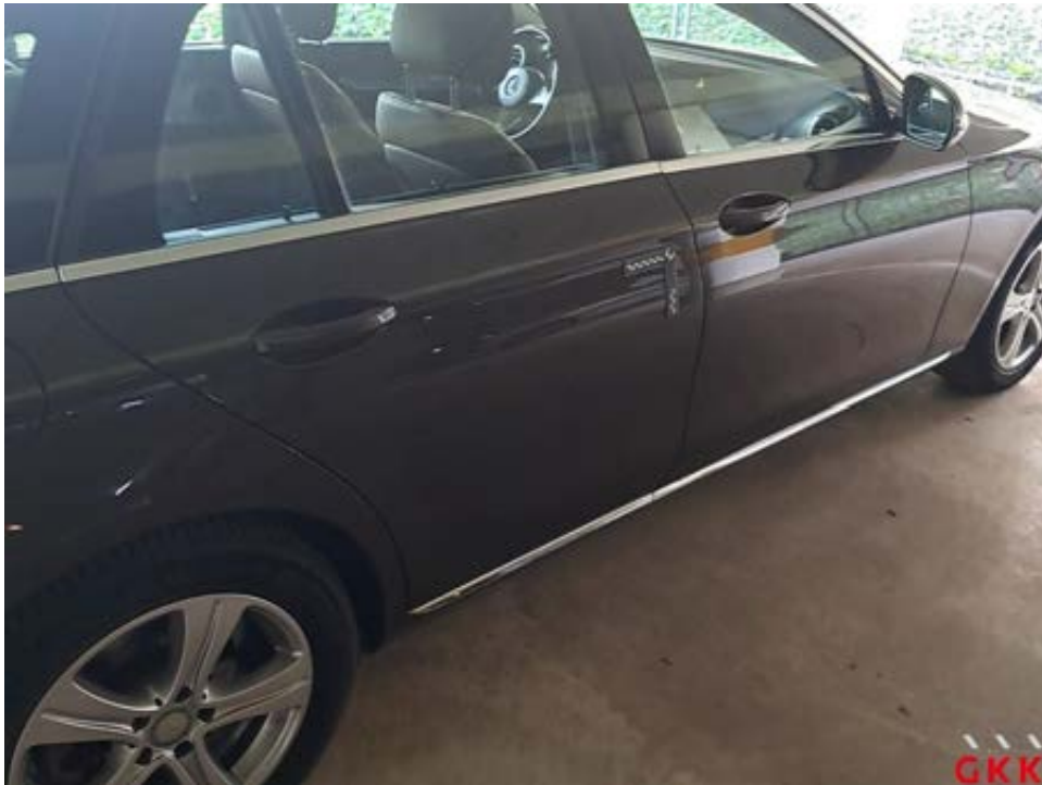
Bild 17 Tür hinten rechts, beschädigt, instand setzen - lackieren
