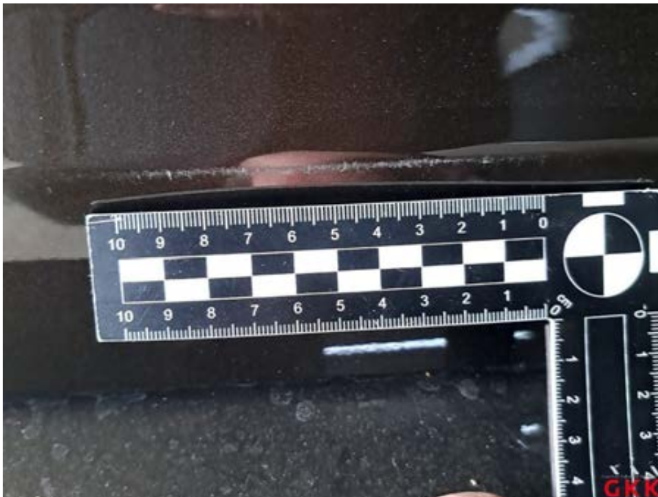
Bild 26 Heckklappe, unterhalb, verkratzt, lackieren
