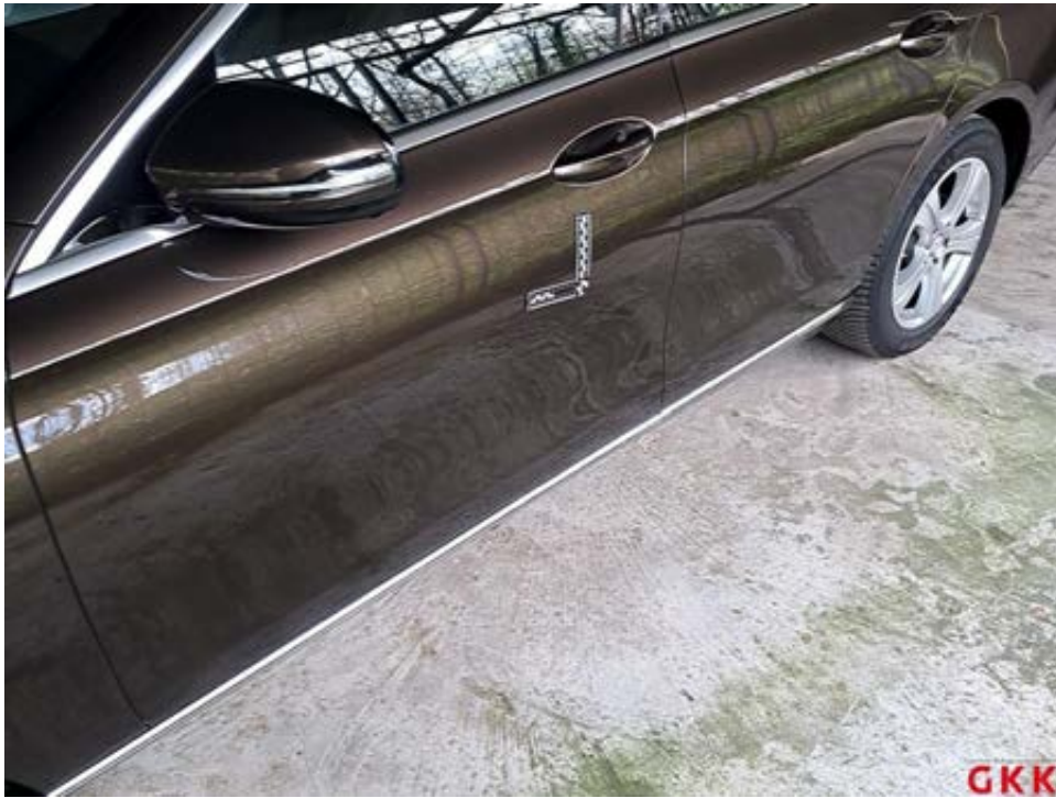
Bild 21 Tür vorne links, beschädigt, instand setzen - lackieren
