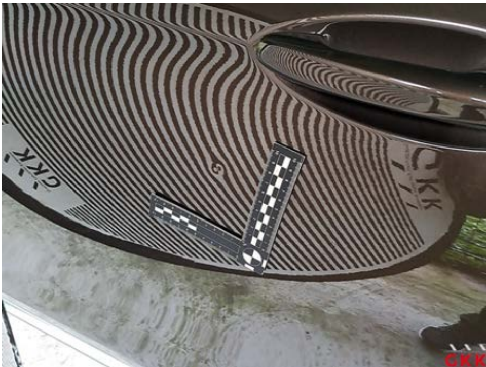
Bild 22 Tür vorne links, beschädigt, instand setzen - lackieren
