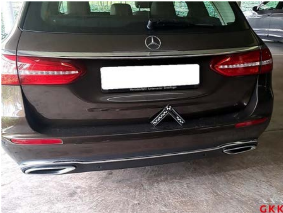
Bild 25 Heckklappe, unterhalb, verkratzt, lackieren
