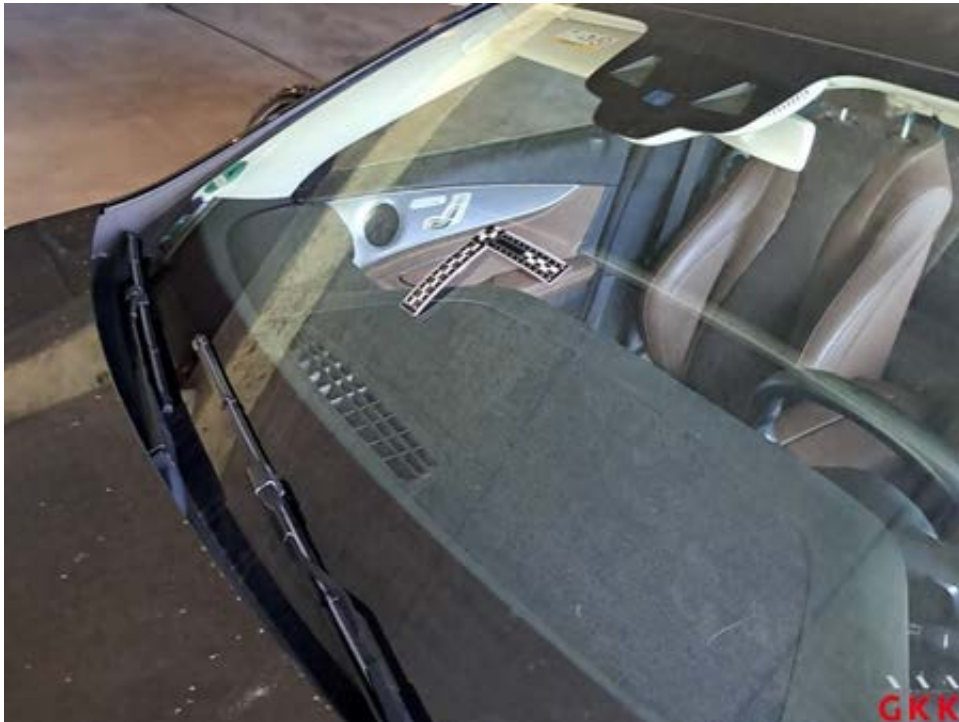
Bild 19 Frontscheibe, beheizt mit Regensensor und Frontkamera, Steinschlag mit Rissbildung, ersetzen
