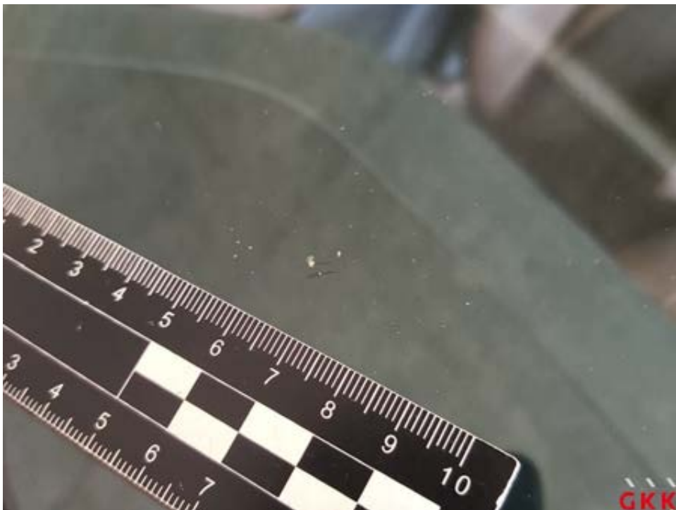
Bild 20 Frontscheibe, beheizt mit Regensensor und Frontkamera, Steinschlag mit Rissbildung, ersetzen
