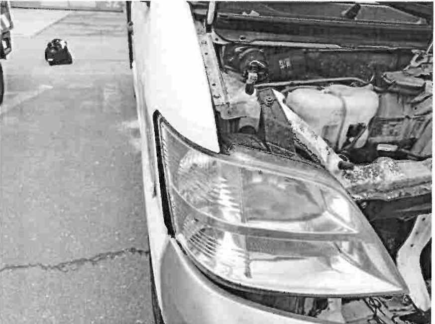
Bild 8: Scheinwerfer rechts gebrochen
