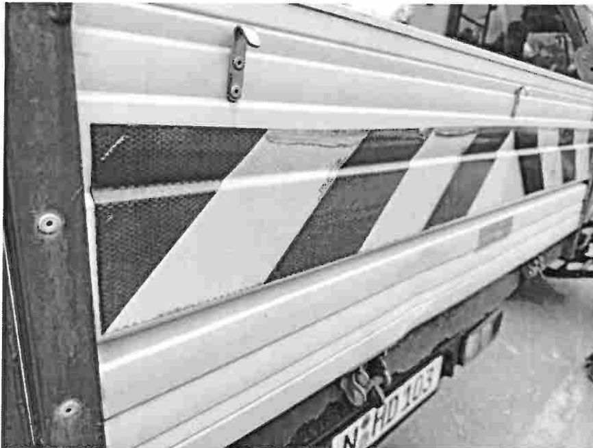
Bild 16: Altschaden: Bordwand hinten deformiert
