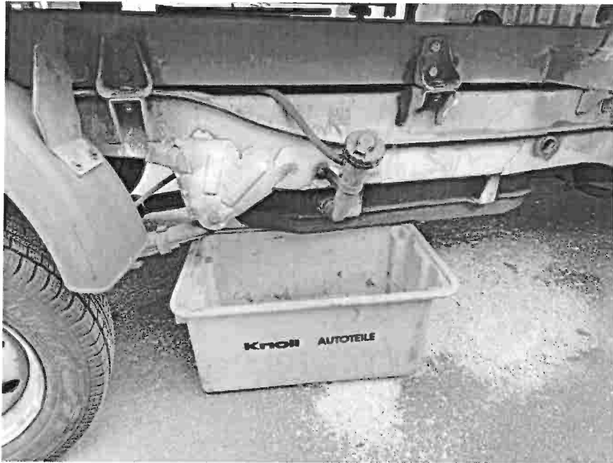
Bild 17: Altschaden: Tank undicht
