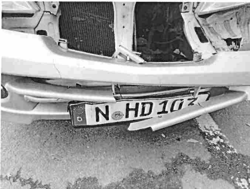
Bild 6: Stoßfänger vorne zerstört, Kennzeichen vorne deformiert
