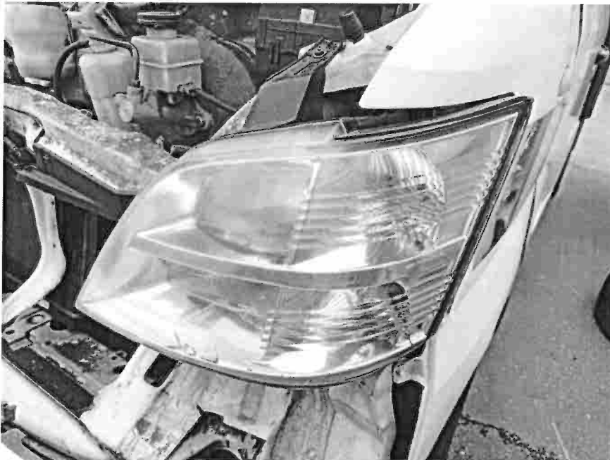
Bild 12: Schweinwerfer lins gebrochen
