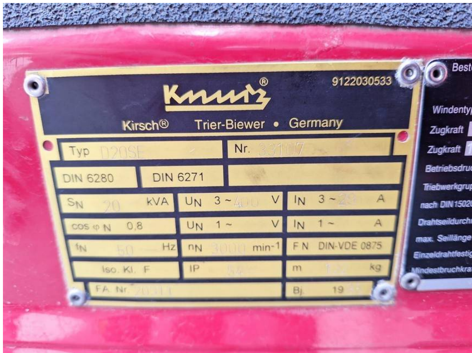
Typschild Stromerzeuger fest eingebaut
