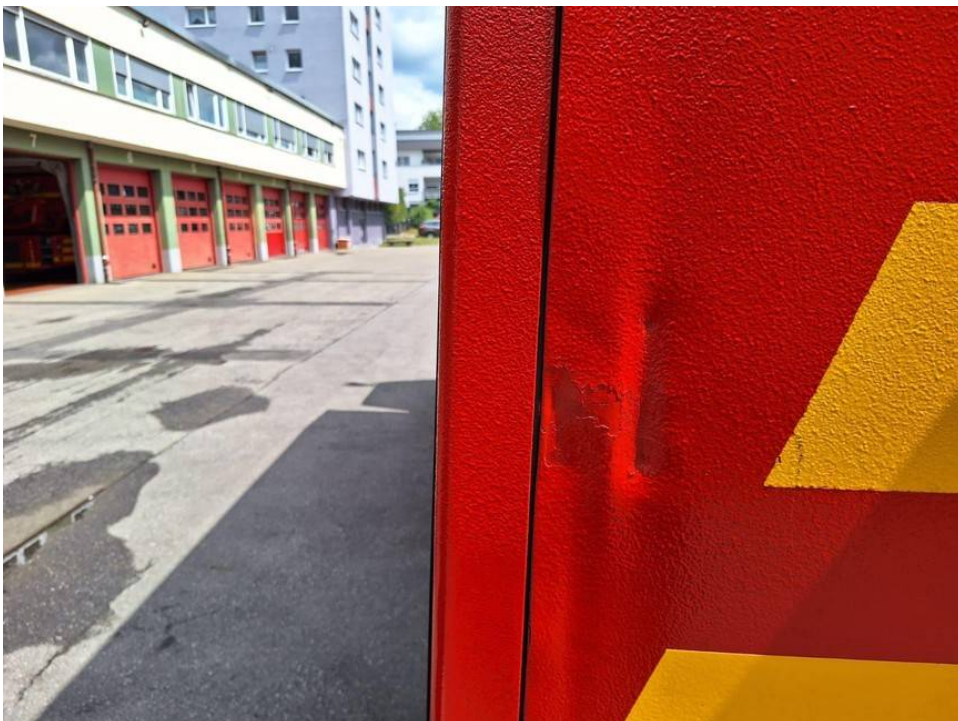
Schaden Klappe Stromerzeuger
