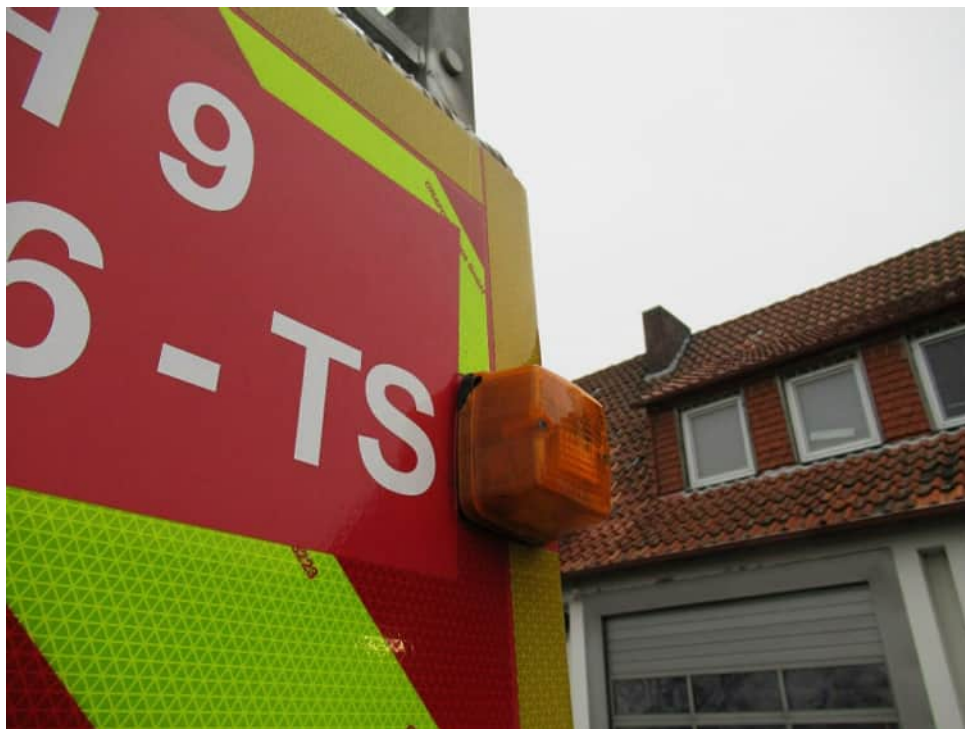
Bild 23 : Blinkleuchte hinten rechts oben gebrochen
