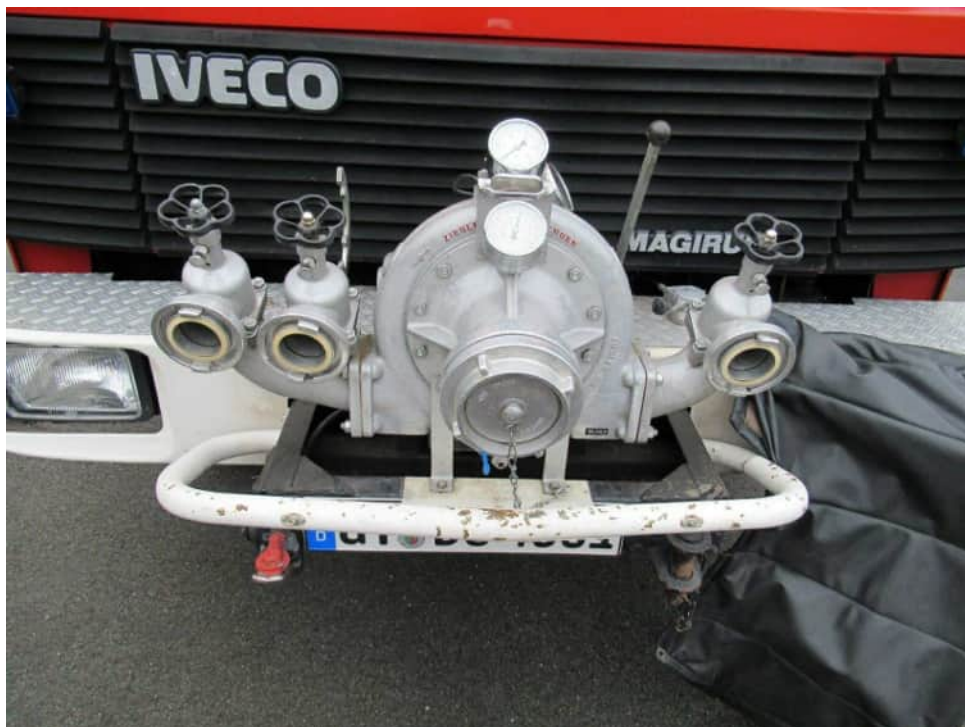
Bild 24 : Vorbaupumpe ohne Funktion
