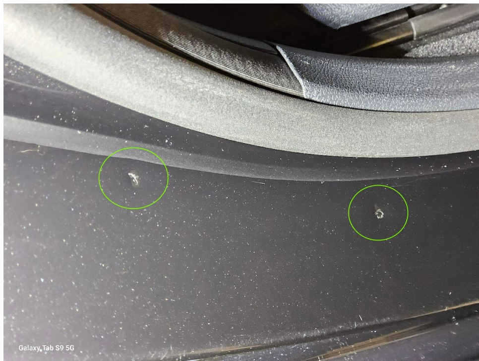
Bild 14 : Türeinstieg vorne rechts mehrfache Lackbeschädigung mit kleinen Dellen
