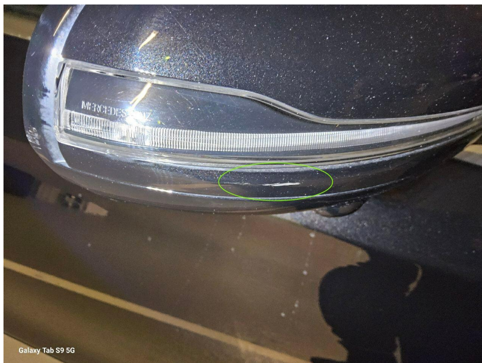
Bild 19 : Außenspiegel rechts Spiegelkappe auf der Kante verkratzt
