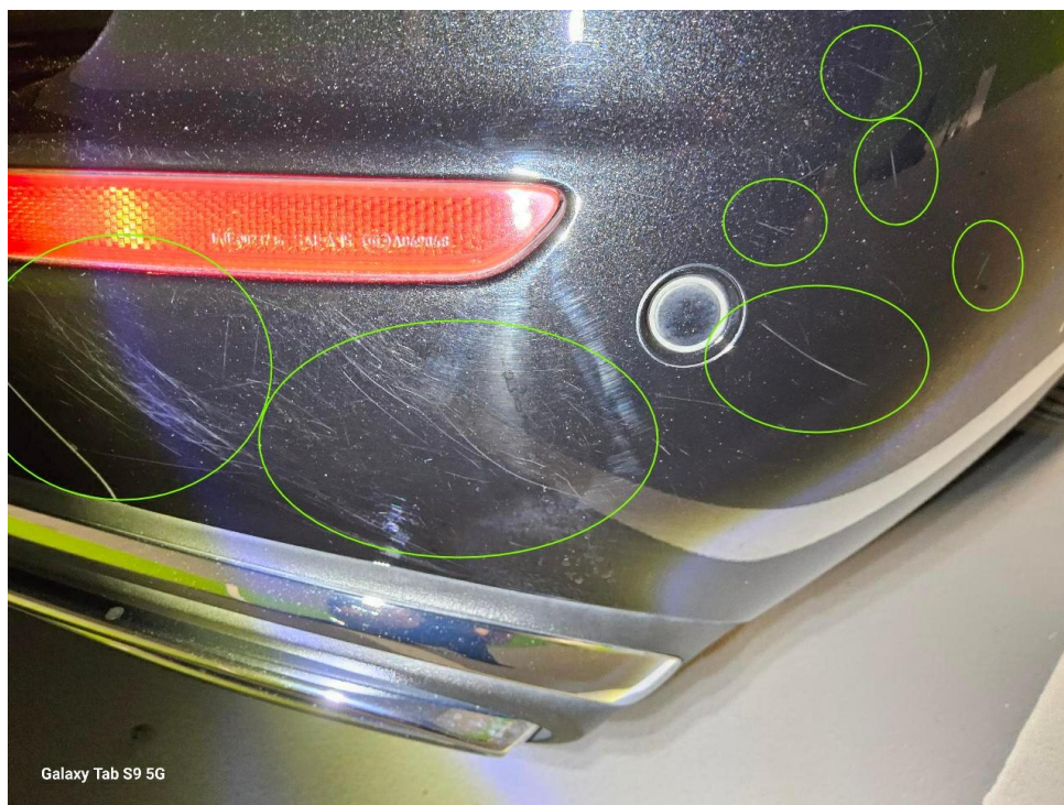
Bild 25 : Stoßfänger hinten viele Kratzer
