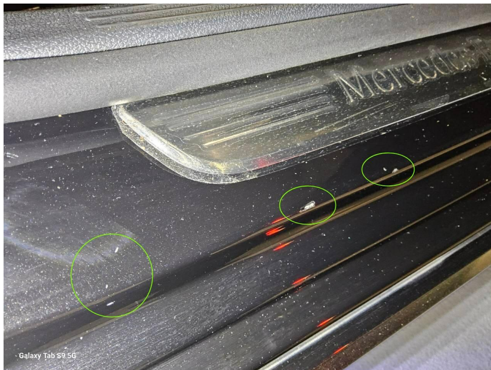
Bild 13 : Türeinstieg vorne rechts mehrfache Lackbeschädigung mit kleinen Dellen
