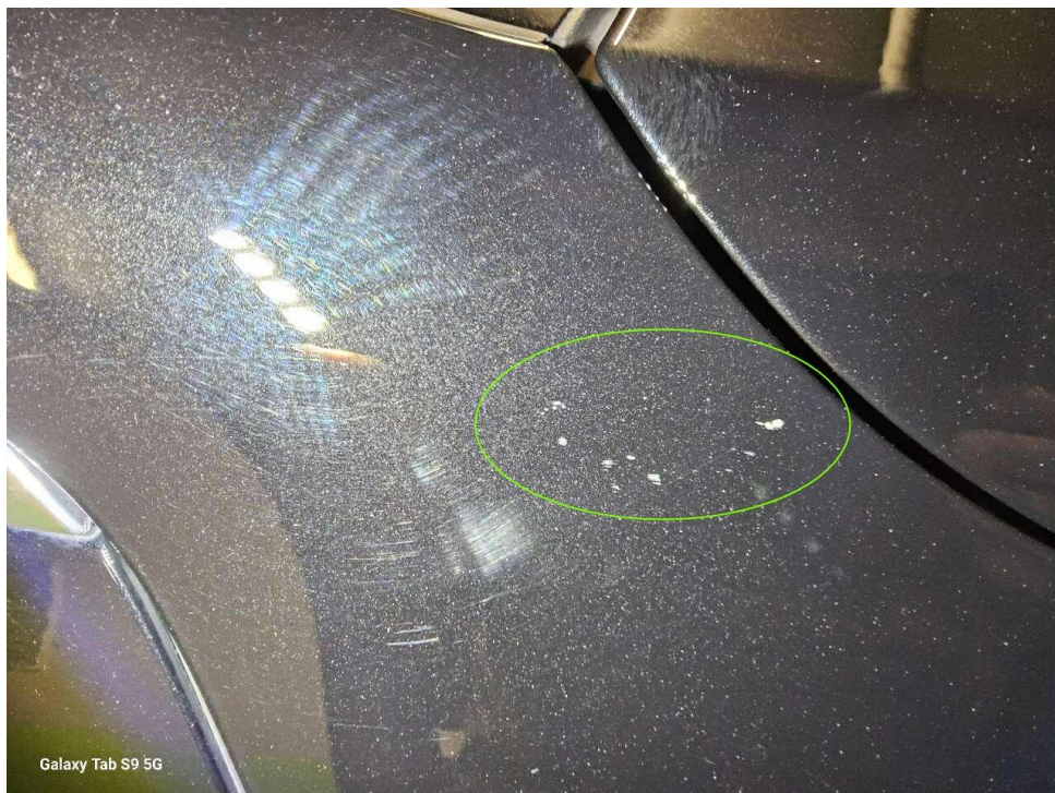
Bild 32 : Kotflügel vorne rechts leichte Kratzer und oberhalb Steinschläge mit leichten Schrammen, auslegen schleifen und polieren
