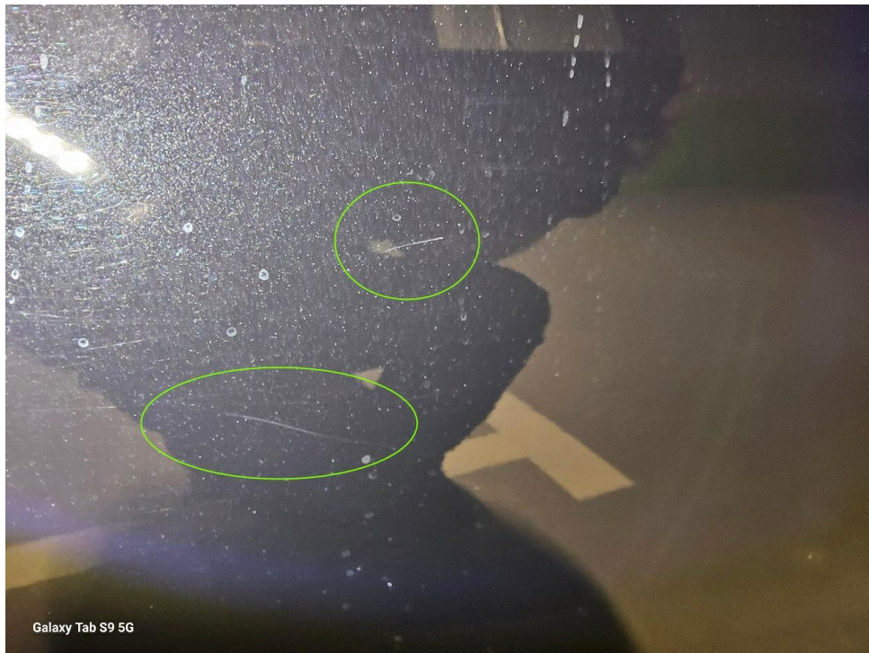
Bild 31 : Tür vorne rechts mehrfach verkratzt
