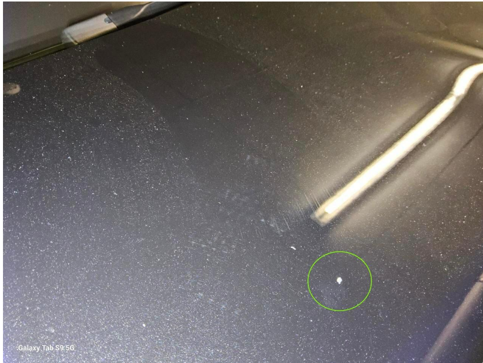
Bild 17 : Motorhaube leichte Kratzer, laufleistungsbedingte Steinschläge, 1 großer Steinschlag oberhalb, auslegen schleifen und polieren
