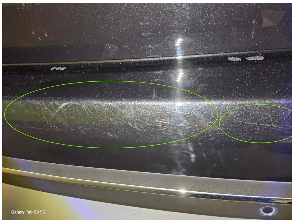
Bild 26 : Stoßfänger hinten viele Kratzer
