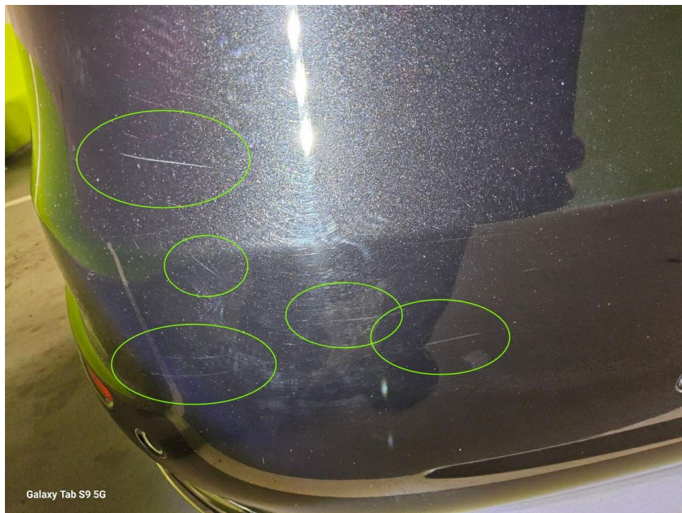
Bild 24 : Stoßfänger hinten viele Kratzer
