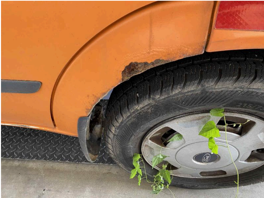
Bild: 11 Radlauf korrodiert
