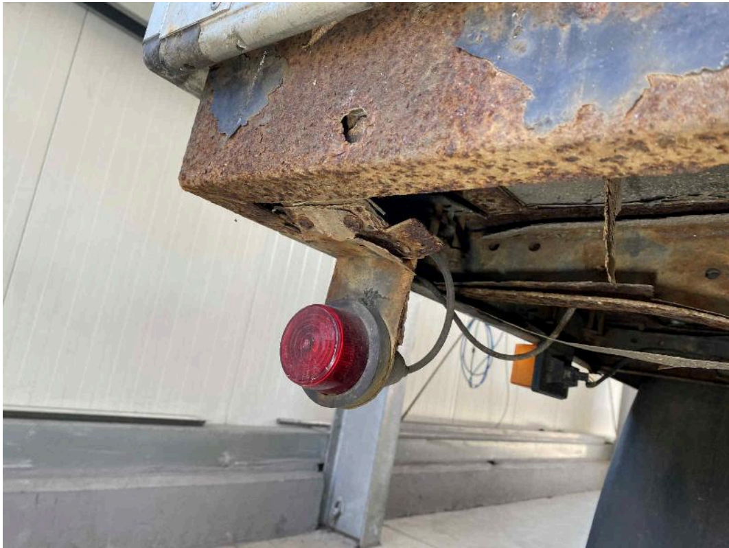
Bild: 13 Pritschenaufbau mehrfach durchgerostet
