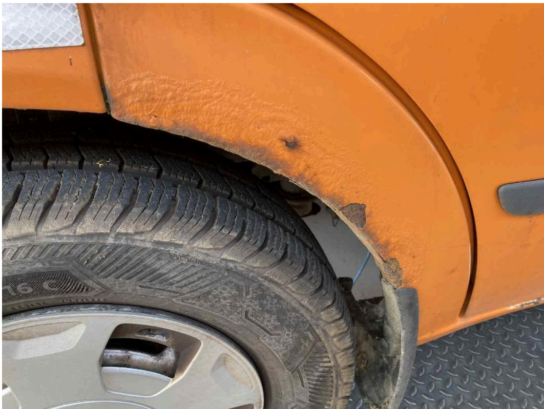
Bild: 12 Radlauf korrodiert
