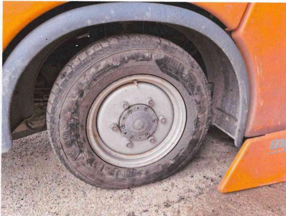
Bild 13 : Druckspuren Reifen vorn
