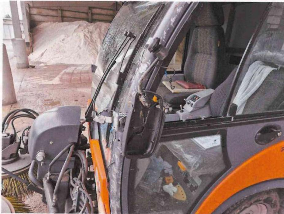
Bild 9 : Anbauteile abgebrochen
