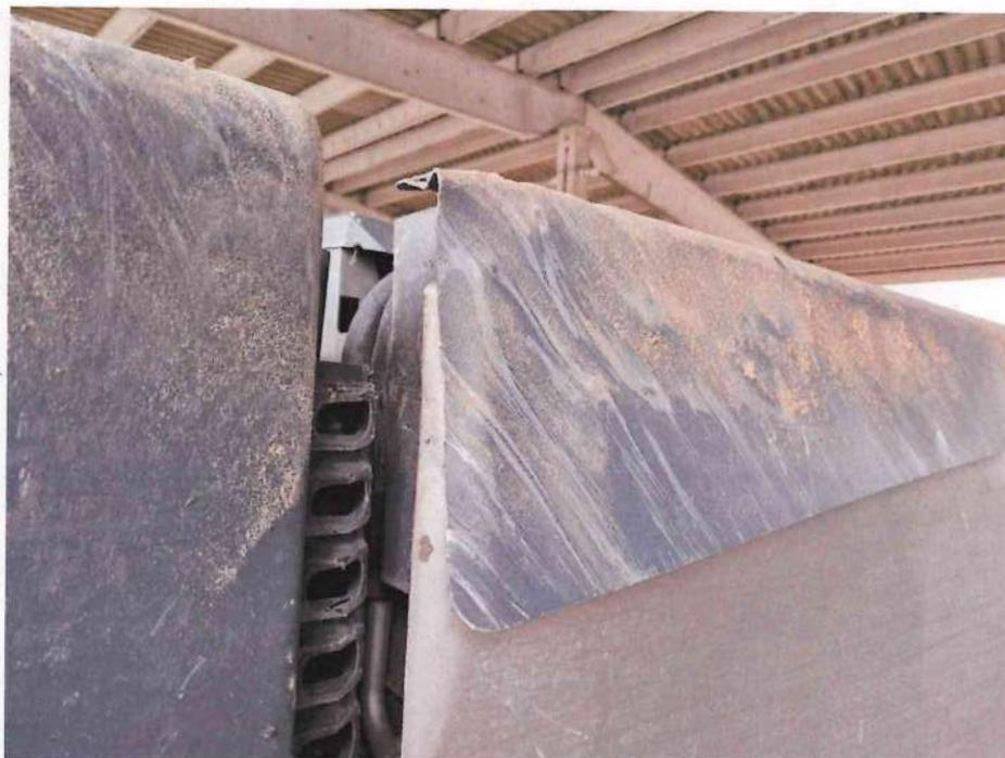
Bild 14 : Aufbau deformiert vorn
