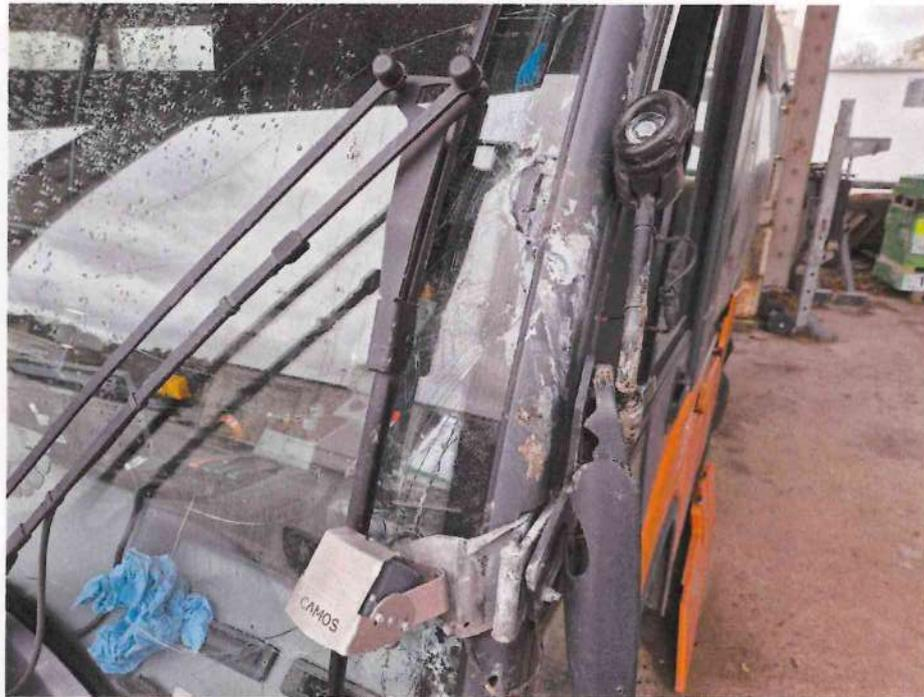
Bild 7 : Sicherheitskabine deformiert
