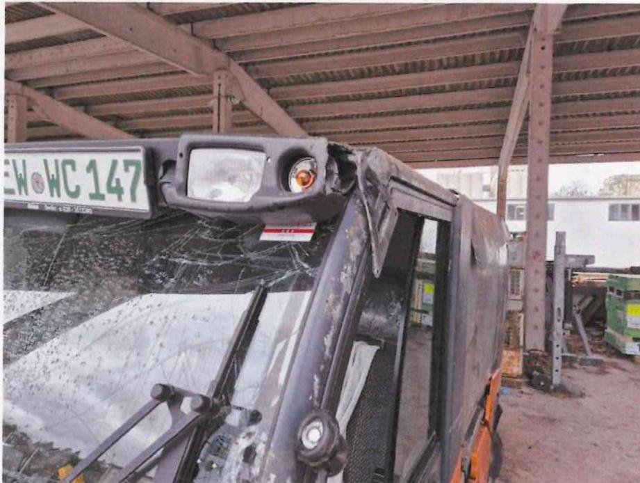
Bild 11 : Anbauteile Zusatzscheinwerfer abgebrochen
