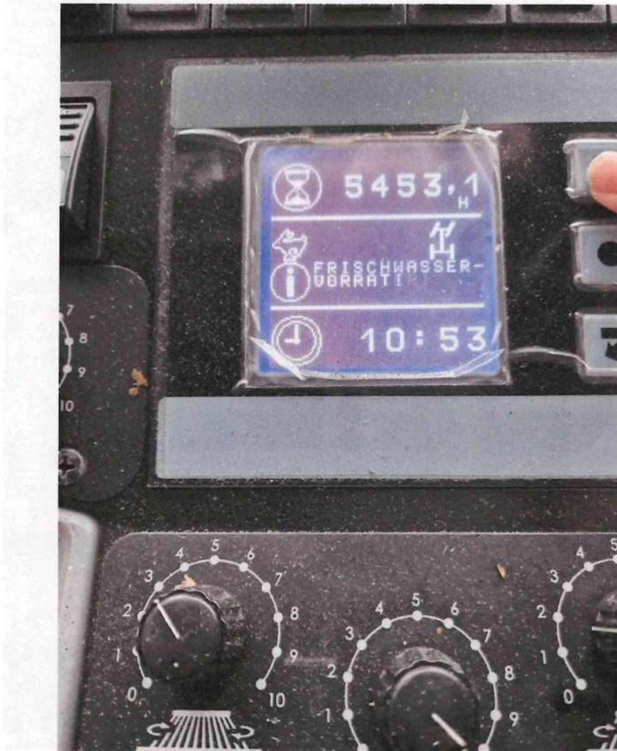
Bild 5 : Instrument Betriebsstunden
