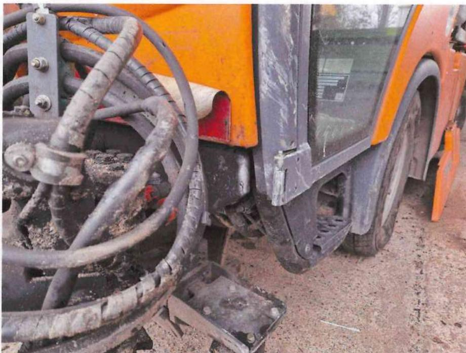
Bild 12 : Tür und Kabine unten deformiert
