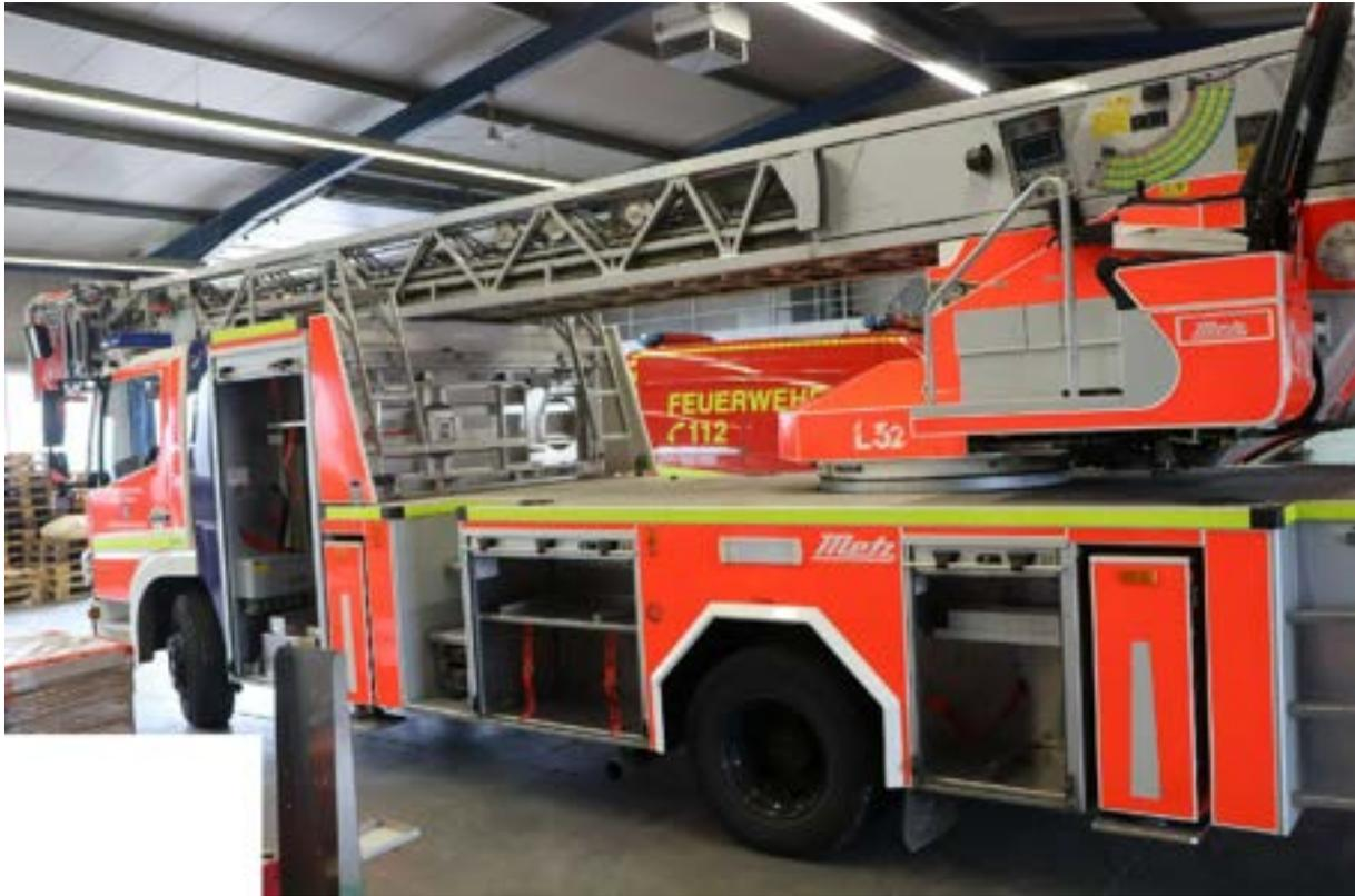
Bild 5: Seitenansicht links mit geöffneten Geräteräumen
