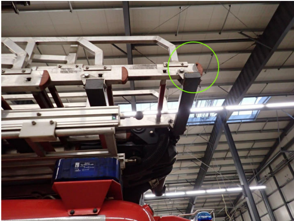
Bild 9 : Leiterpark vorne angestoßen und örtlich deformiert
