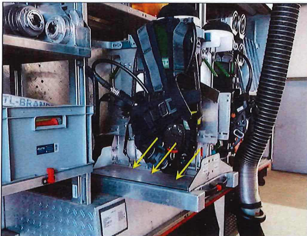
Bild 32 Halterung auf Auszug für Atemschutzausrüstung in G1 lose
