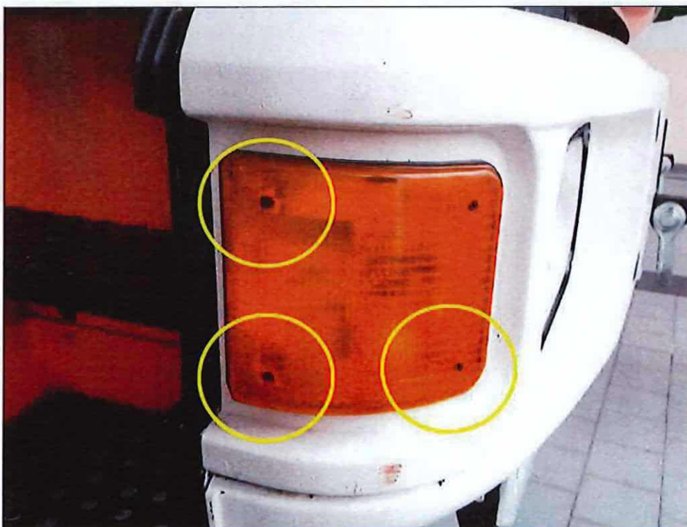
Bild 26 gerissene Lichtscheiben am Beispiel des Blinkers vorne rechts
