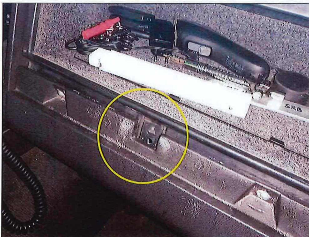
Bild 24 Schloss Handschuhfach defekt
