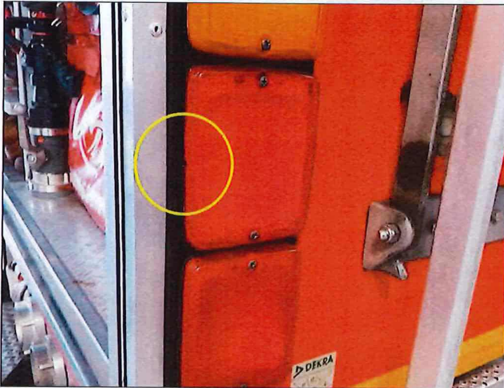
Bild 27 gerissene Lichtscheibe des linken Rücklichts
