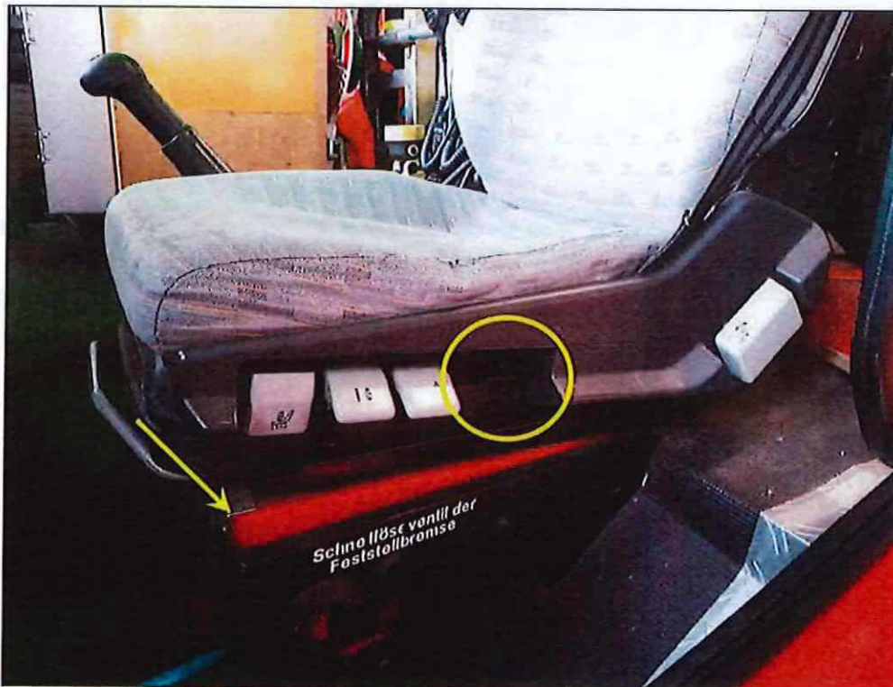
Bild 28 Belägung Sitzhöhenverstellung fehlt und die Verkleidung des Sitzgestell lose
