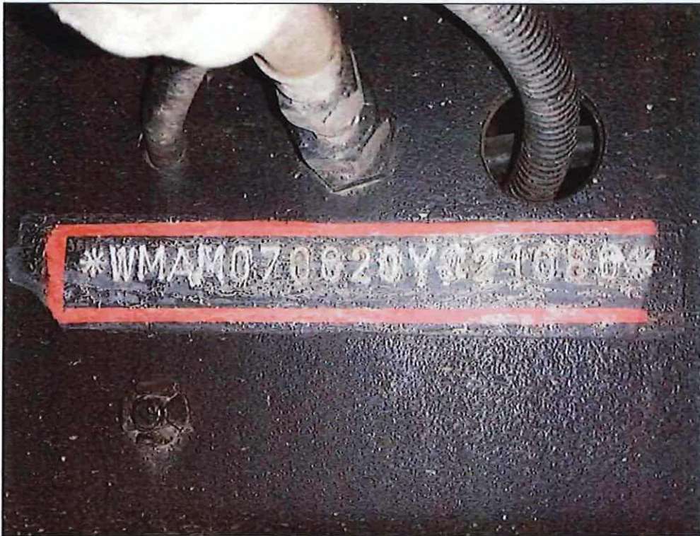
Bild 9 Eingeschlagene Fahrzeug-Ident-Nr. (FIN) – Fahrzeugrahmen vorne rechts
