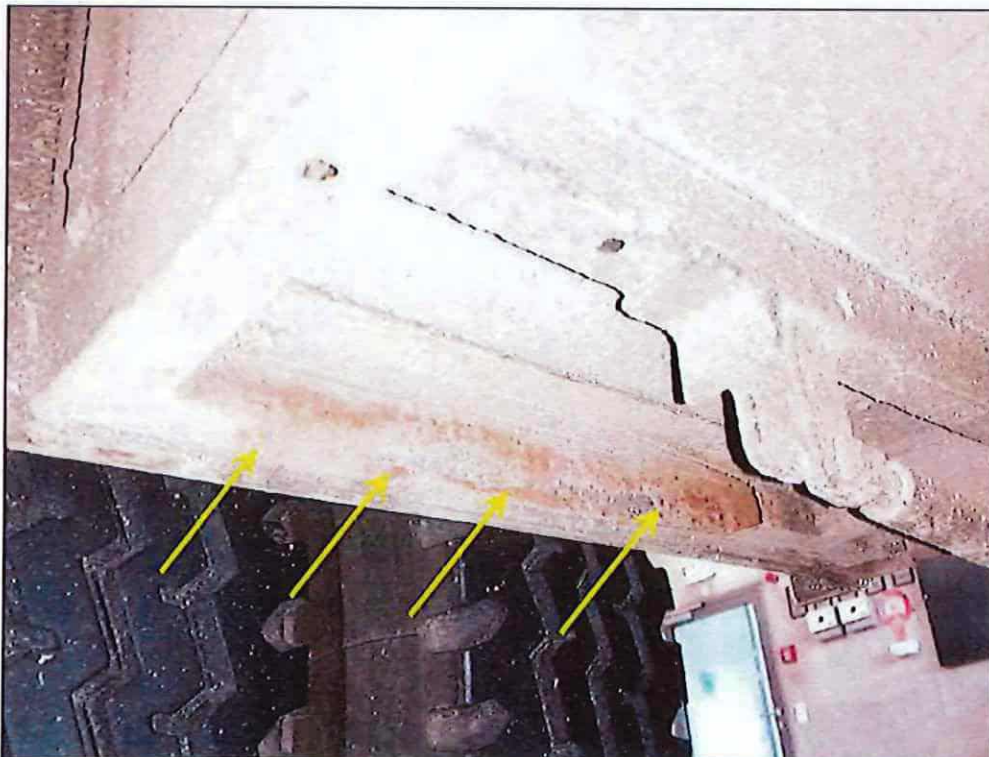
Bild 34 Korrosionserscheinungen am vorderen linken Radlauf der Hinterachse von unten
